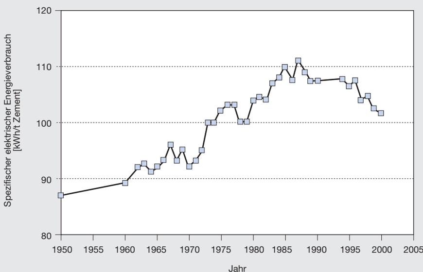
Abb. 13: Entwicklung des spezifischen elektrischen Energieverbrauchs in der Zementproduktion, ab 1987 inklusive ostdeutscher Werke (Quelle: VDZ 2002a)
